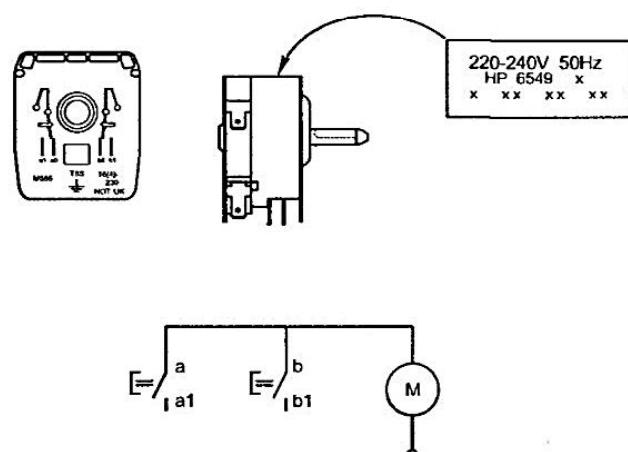
Рис. 10.8. Схема таймера сушки
