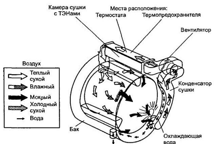
Рис. 10.2. Схема процесса сушки
