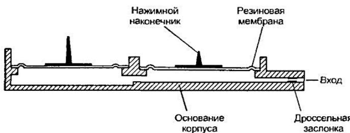
Рис. 6.11. Устройство нижней части 2-уровневого датчика давления
