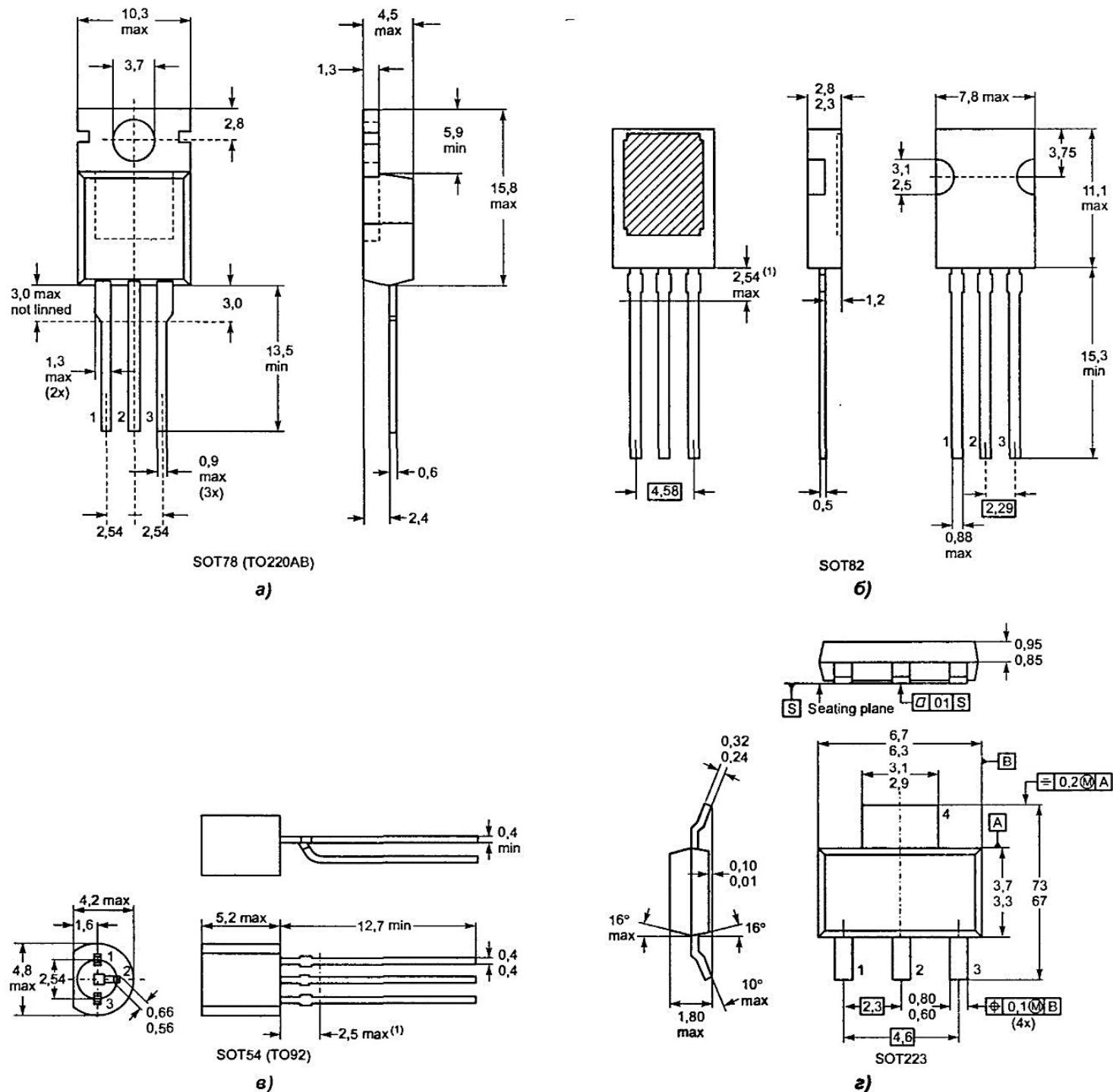
Рис. 16.7. Типоразмеры корпусов симисторов
