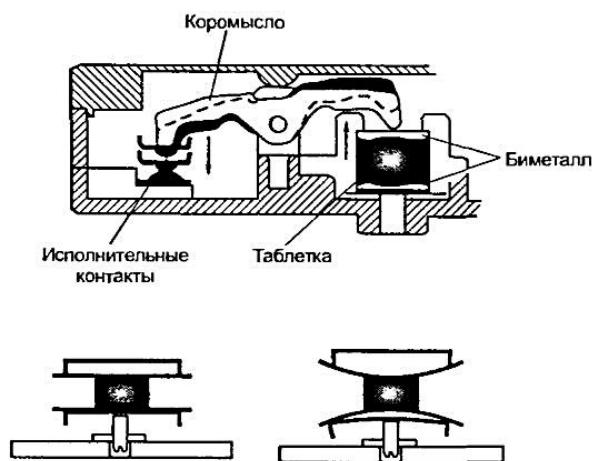
Рис. 7.7. Принцип действия термозамка с круглым термоэлементом в виде таблетки
