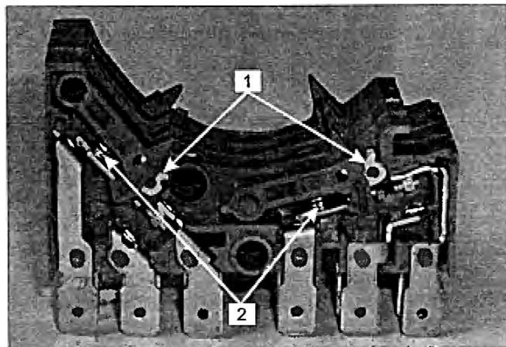
Рис. 11.16. Устройство контактной галеты под разъем
