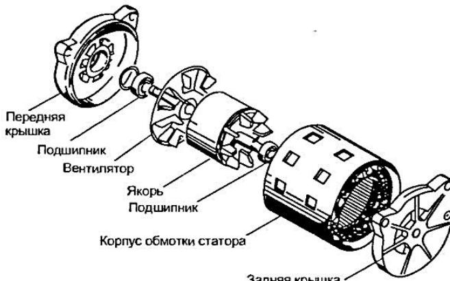
Рис. 12.3. Устройство асинхронного мотора
