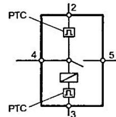
Рис. 7.10. Электрическая схема термозамка с электромагнитом
