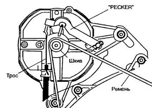
Рис. 7.14. Принцип действия механической блокировки
