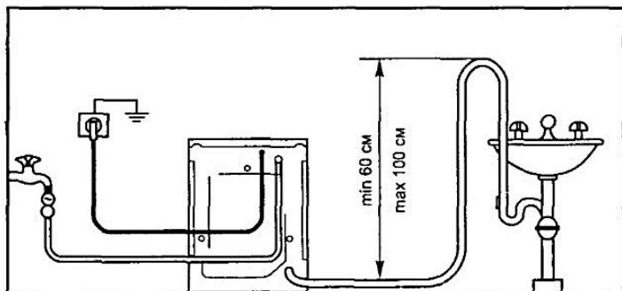
Рис. 15.1. Схема стандартного подключения СМА
