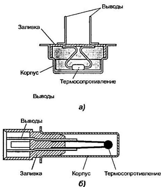
Рис. 9.13. Устройство термисторов
