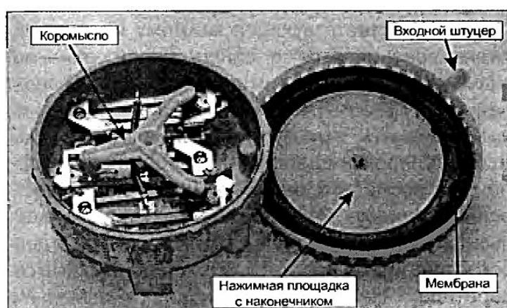
Рис. 6.8. Трехуровневый датчик давления
