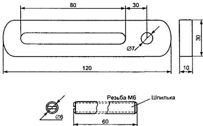
Рис. 18.9. Чертежи приспособлений для снятия готовых углов вращения
