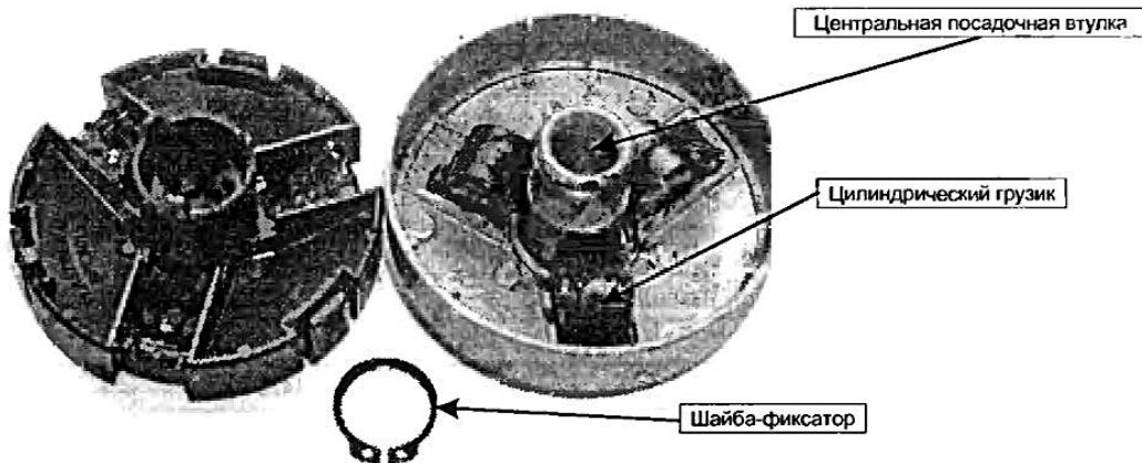
Рис. 12.7. Устройство шкива-вариатора
