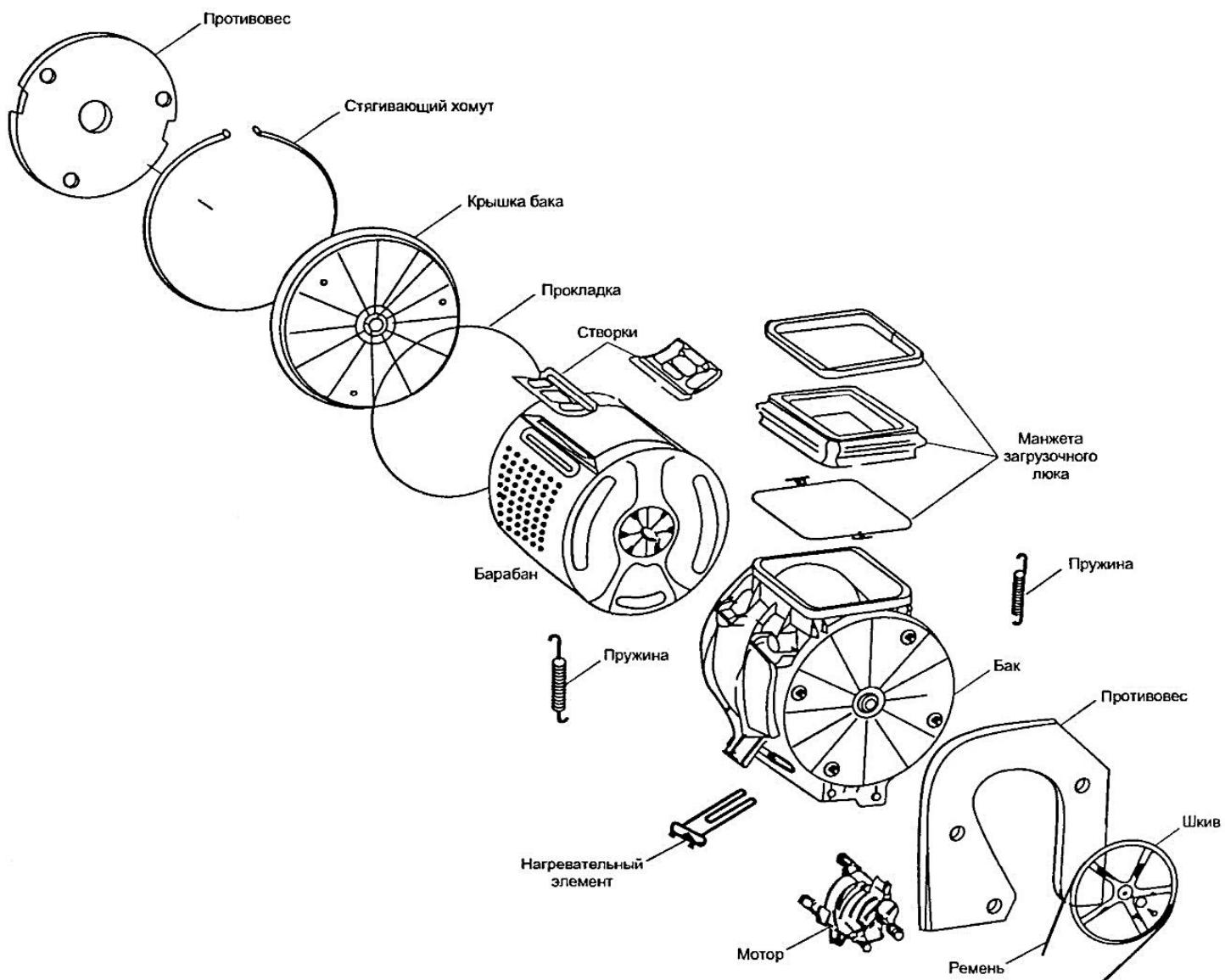
Рис. 1.16. Основные детали СМА с вертикальной загрузкой
