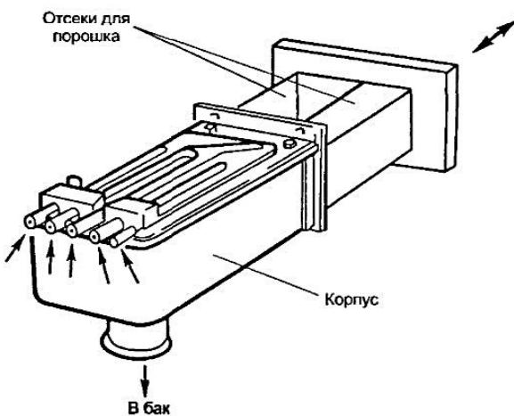
Рис. 2.2. Тип выдвижного лотка
