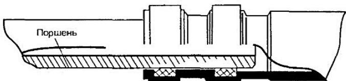
Рис. 1.14. Фрикционный демпфер с двумя прокладками
