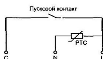
Рис. 7.3. Схема термозамка
