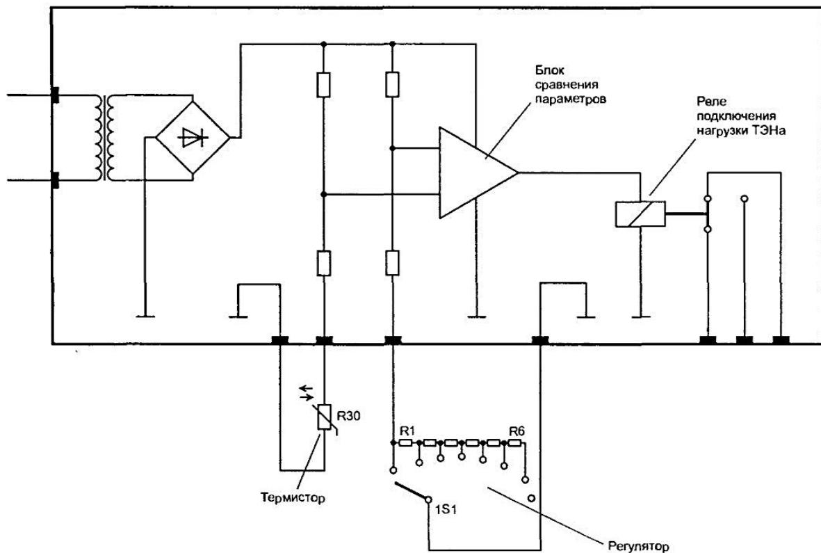
Рис. 9.17. Фрагменты измерительной схемы
