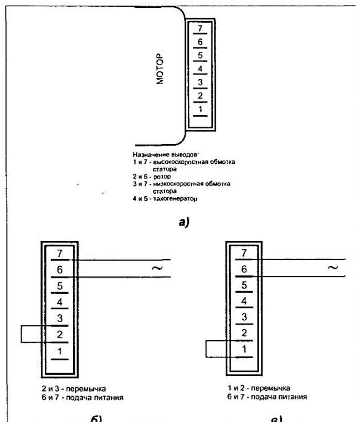
Рис. 16.18. а) Назначение выводов, б) Проверка низкоскоростной обмотки, в) Проверка высокоскоростной обмотки
