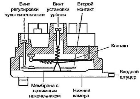
Рис. 6.6. Устройство пневматического датчика давления
