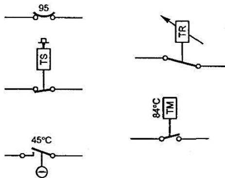
Рис. 9.11. Примеры обозначений термостатов на электросхемах
