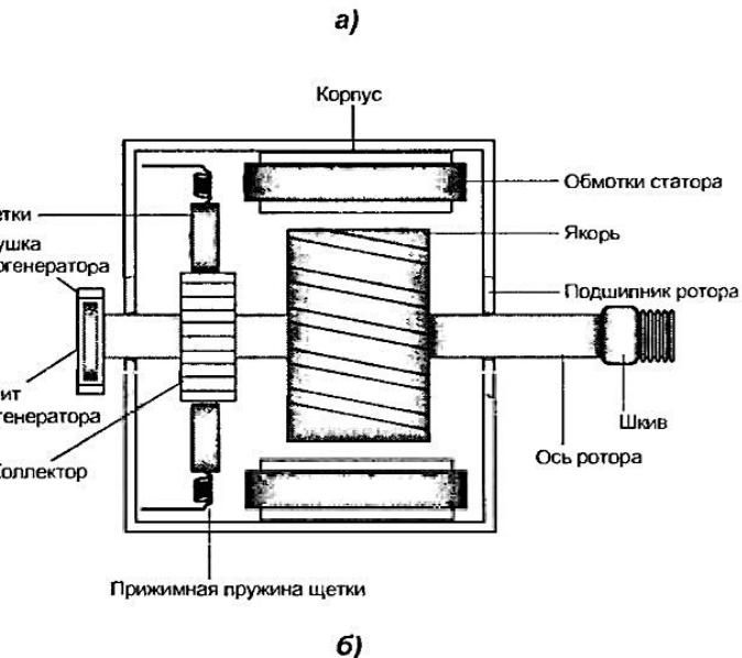
Рис. 12.11. Устройство коллекторного мотора
