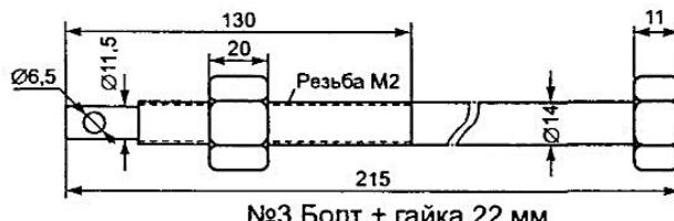
№3 Болт + гайка 22 мм
