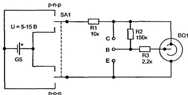
Рис. 16.5. Схема простейшего прибора для проверки маломощных биполярных транзисторов
