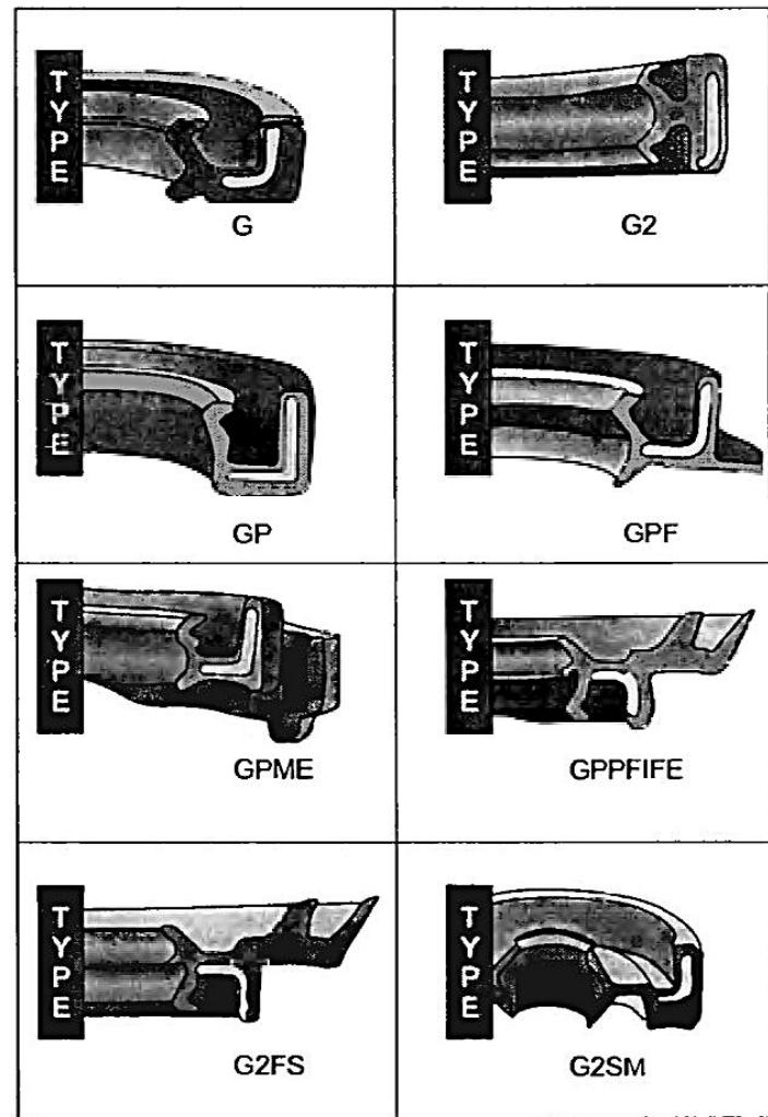
Рис. 13.4. Профили распространенных типов манжет
