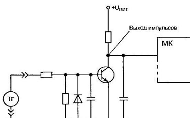
Рис. 12.15. Схема формирователя импульсов
