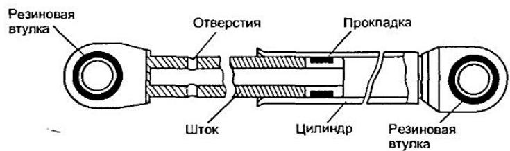
Рис. 1.13. Устройство демпфера с фрикционной прокладкой
