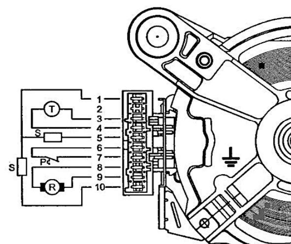
Рис. 12.18. Мотор с внешними контактами термопредохранителя
