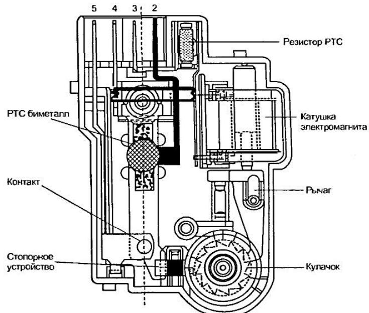
Рис. 7.9. Чертеж термозамка с электромагнитом
