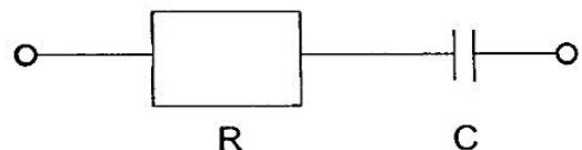
а номиналы ее элементов указаны на корпусе, например, как на рис. 3.3. Подобные цепочки включаются обычно параллельно контактам датчика давления и электромагнитных клапанов, чтобы снизить искровые помехи, возникающие при переключениях.
