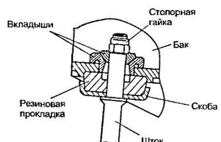
Рис. 1.8. Вариант крепления штока амортизатора к баку СМА .
