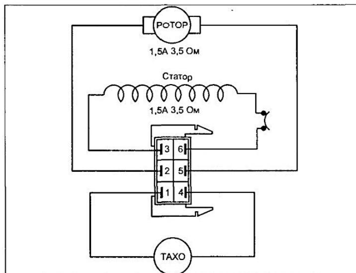
Рис. 16.20. Схема мотора «Selni»
