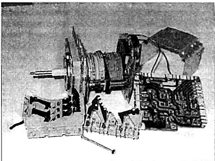
Рис. 11.12. Программатор с печатной платой — тип 2
