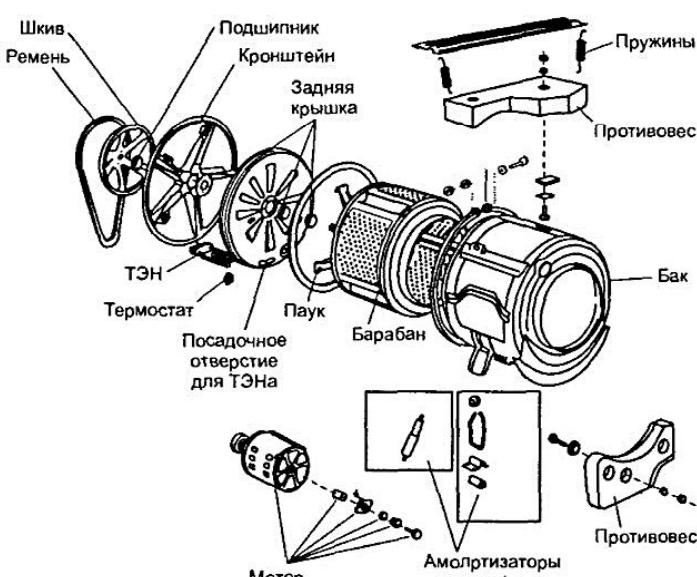
Рис. 1.4. Вариант компоновки СМА с фронтальной загрузкой
