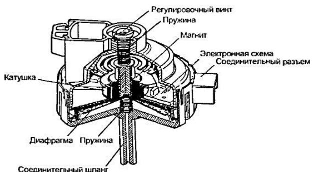
Рис. 6.14. Принцип работы индуктивного датчика давления
