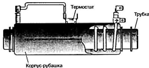
Рис. 8.5. Устройство нагревательного элемента проточного типа
