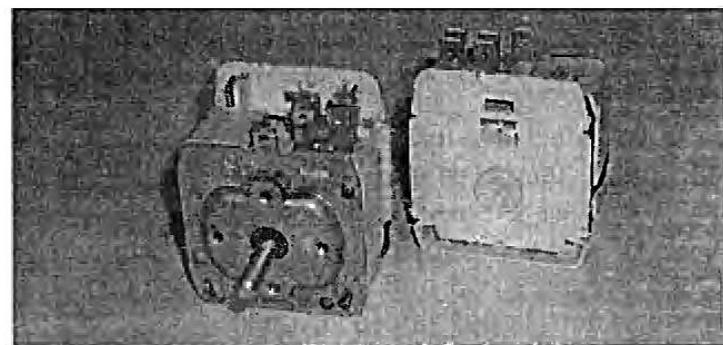
Рис. 10.7. Внешний вид таймера сушки
