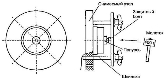
Рис. 18.10. Пример использования приспособления для снятия готовых узлов вращения
