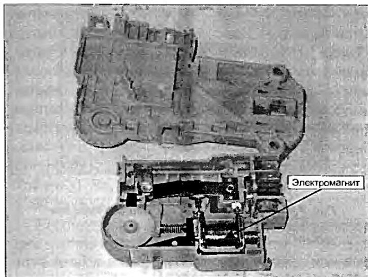
Рис. 7.8. Термозамок с электромагнитом
