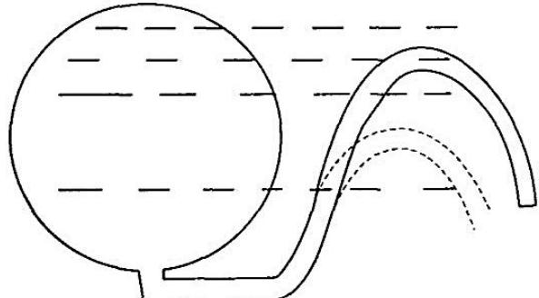
Рис. 15.2. Схема системы «бак+сливной шланг»
