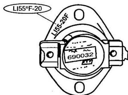
Рис. 9.4. Пример обозначения температур срабатывания
