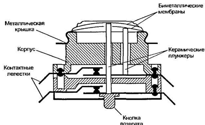
Рис. 9.6. Устройство сдвоенного термостата
