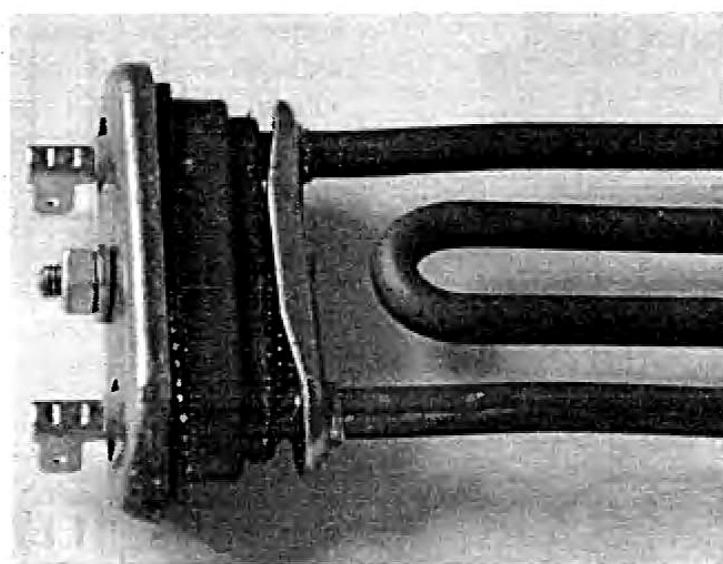
*Рис. 8.10. Бракованный нагревательный элемент*
