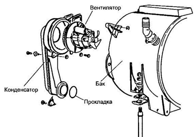
Рис. 10.1. Тип конденсатора сушки с вентилятором
