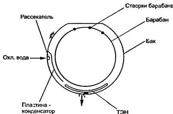
Рис. 10.6. Схема СМА с сушкой без наружного конденсатора
