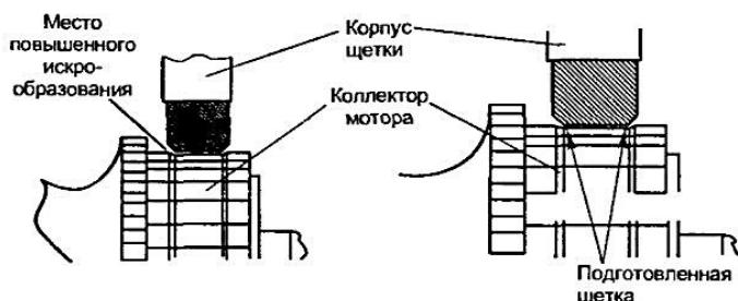
Рис. 16.10. Заключительный этап установки новых щеток
