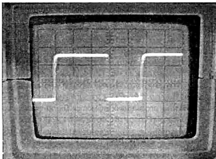
Рис. 12.16. Форма импульсов на выходе формирователя
