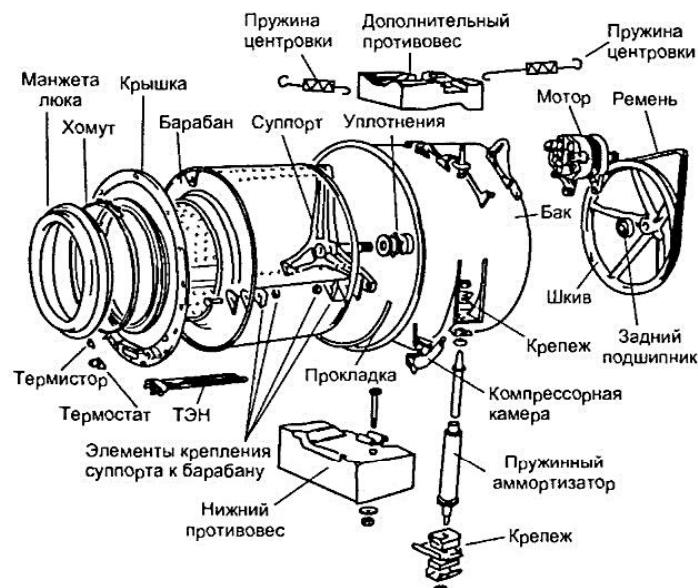
Рис. 1.10. Компоновка СМА с двумя пружинно-поршневыми амортизаторами
