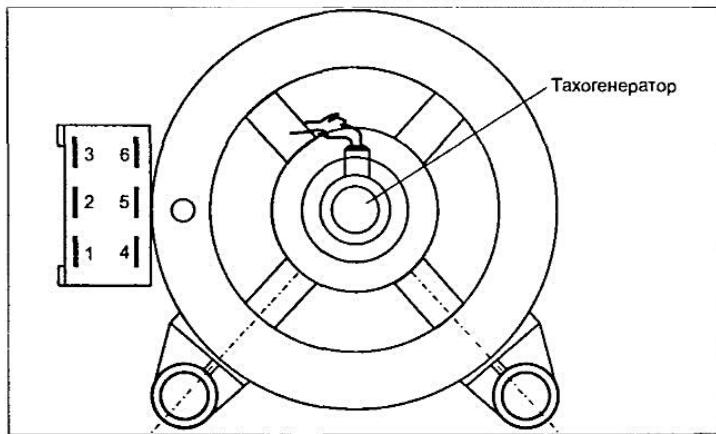
Рис. 16.19. Разъем мотора «Sole»
