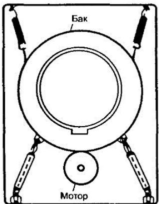
Рис. 1.12. «Классическая» схема подвески бака
