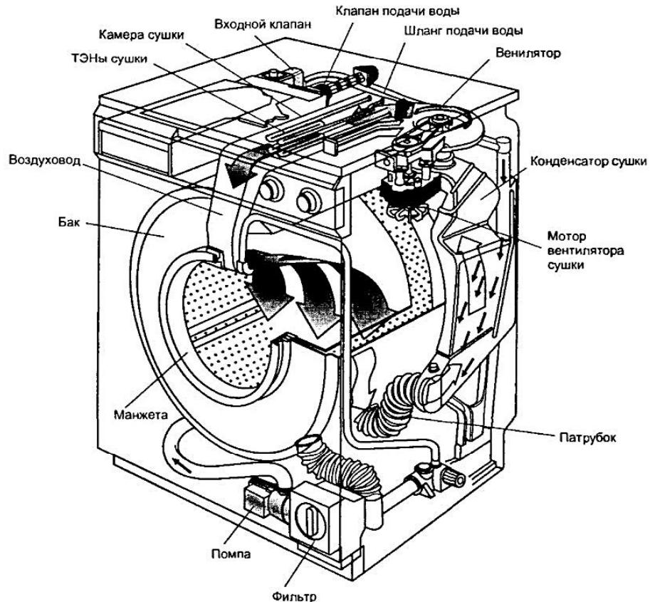
Рис. 10.10. Схема процесса сушки в современной СМА
