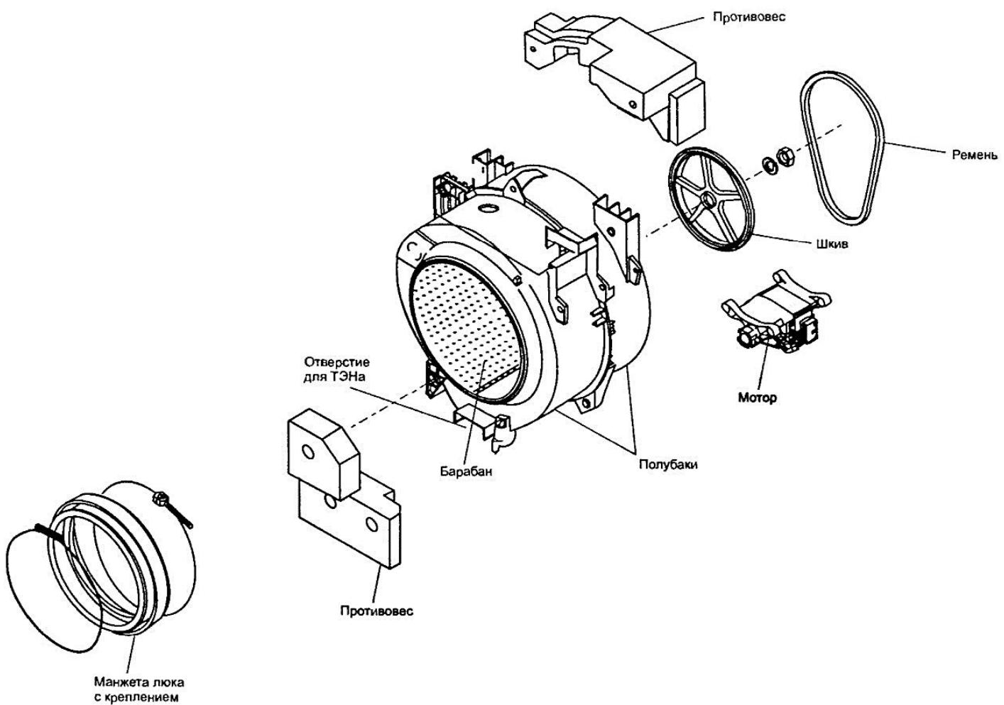
Рис. 1.11. Конструкция пластикового бака из двух частей
