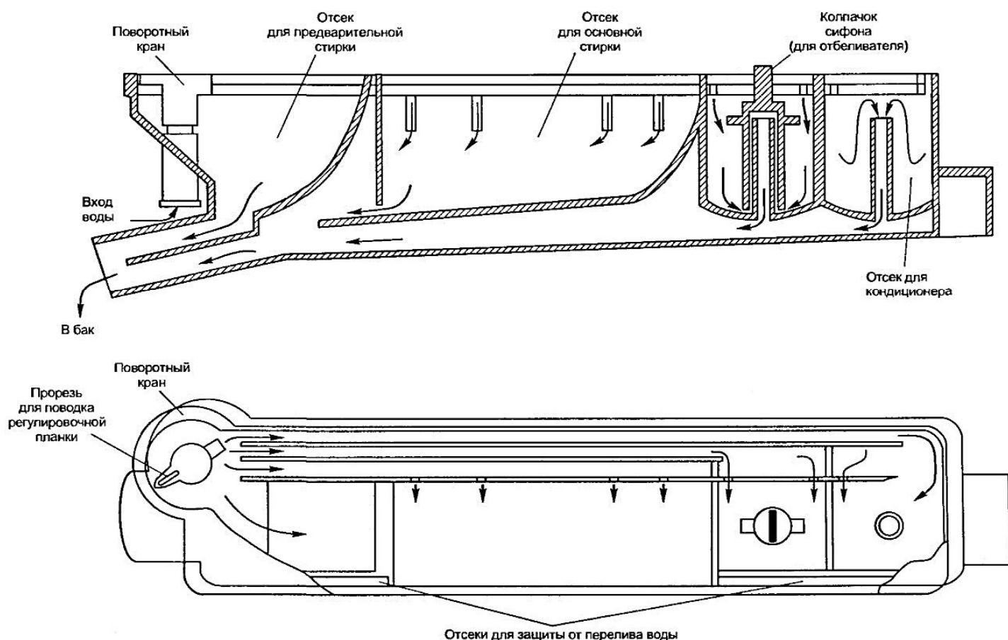
Рис. 2.5. Устройство диспенсера СМА с вертикальной загрузкой
