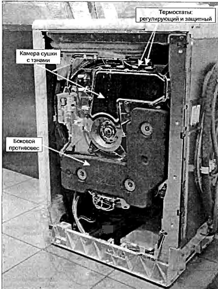
Рис. 10.3. СМА вертикальной загрузки с сушкой
