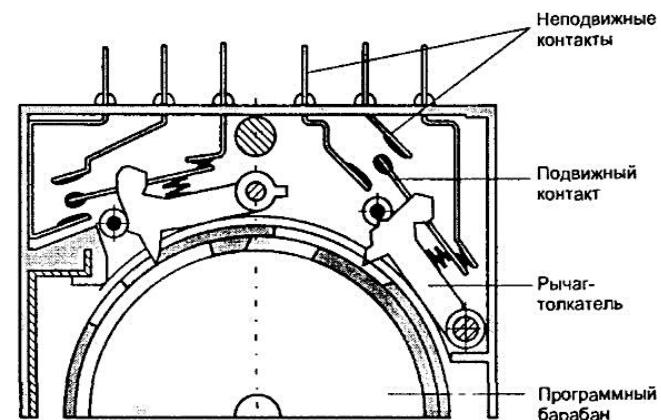
Рис. 11.4. Процесс переключения контактов
