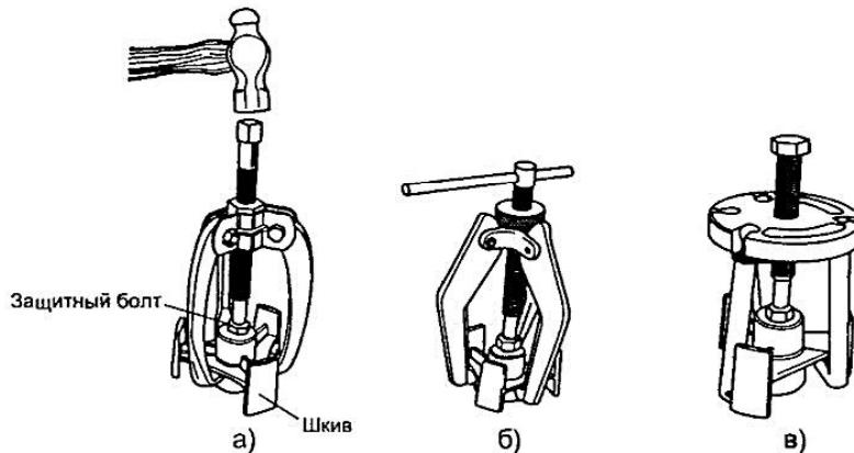
Рис. 18.11. Съемники для снятия шкивов
