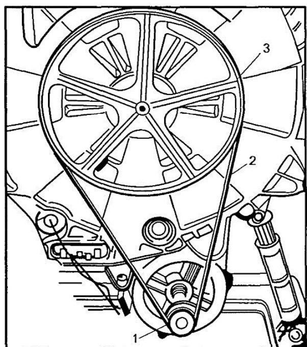
Рис. 12.1. Ременная передача
