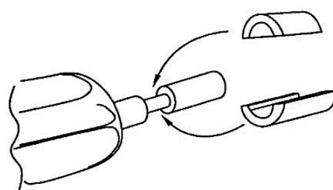
Рис. 16.2. Восстановление оси ротора
