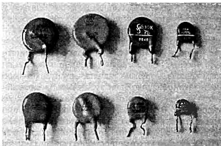
Рис. 16.4. Типы защитных варисторов
