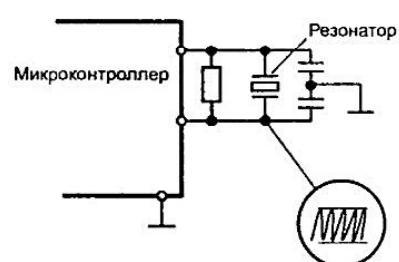
Рис. 16.8. Фрагмент схемы СМ с микроконтроллером
