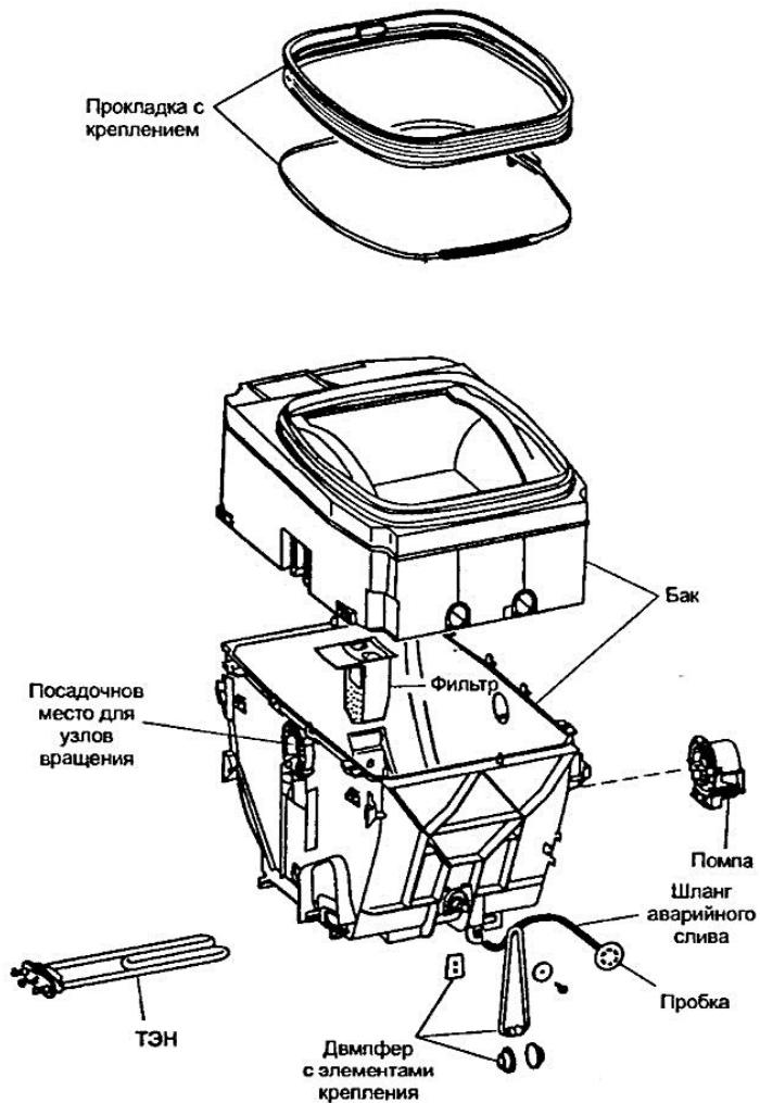
Рис. 1.19. Компоновка СМА вертикальной загрузки
