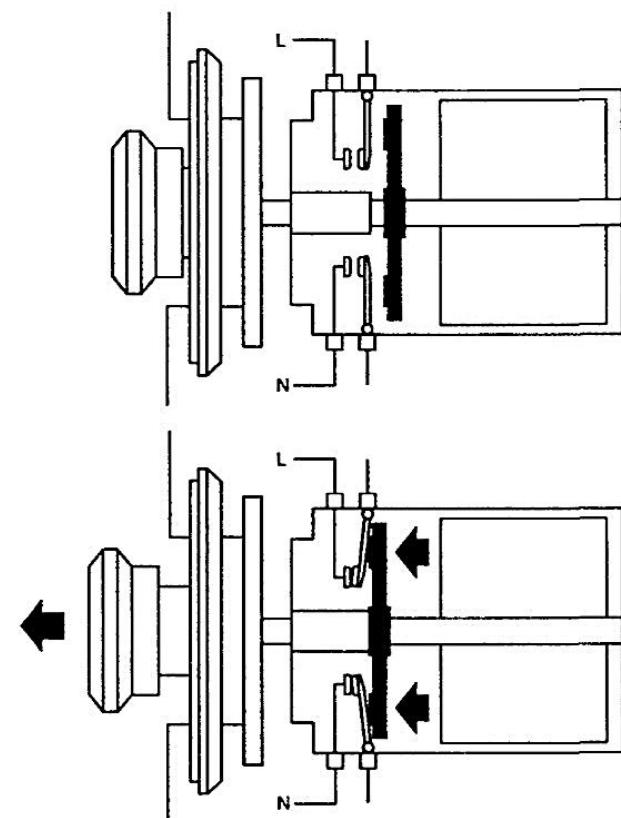
Рис. 11.5. Устройство программатора со встроенным выключателем
