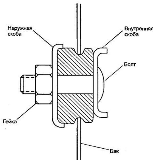
*Рис. 8.8. Закрепление нагревательного элемента в металлическом баке*
