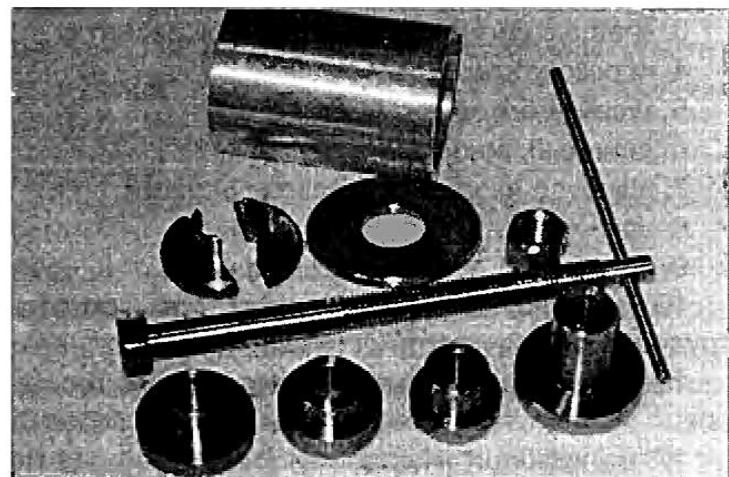
Рис. 18.5. Комплект приспособлений для извлечения и замены подшипников
