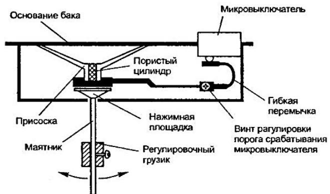
Рис. 1.20. Система автобалансировки
