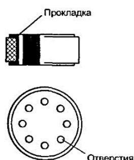
Рис. 1.7. Строение поршня амортизатора
