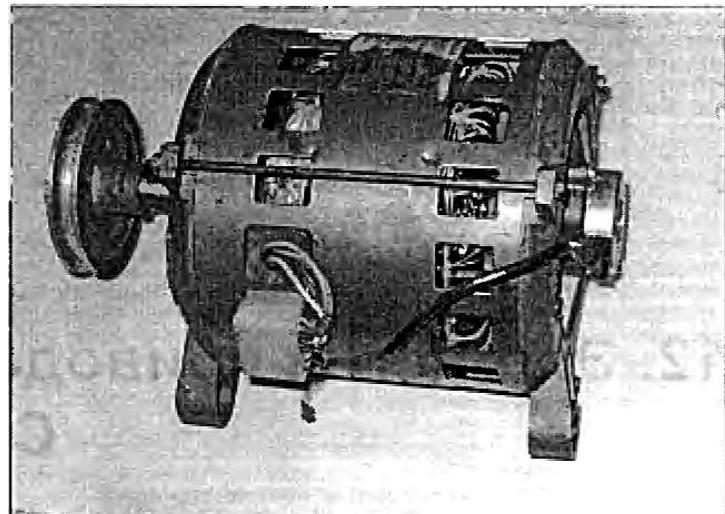
Рис. 12.5. Асинхронный мотор с тахогенератором
