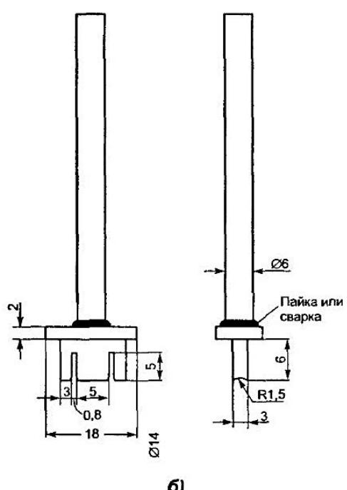
Рис. 18.2. Приспособление для запрессовки проводов в разъемы
