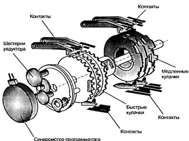
Рис. 11.1. Устройство электромеханического программатора
