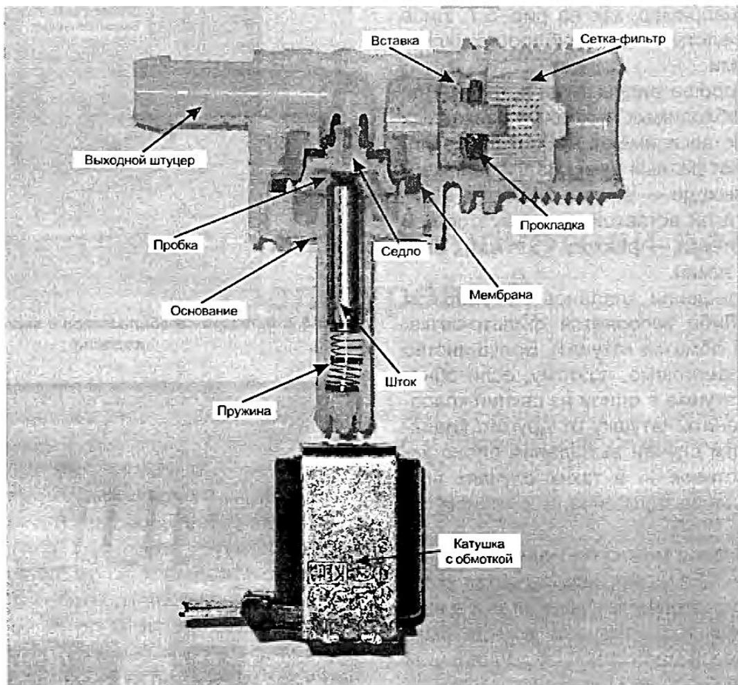
Рис. 5.3. Устройство одинарного электроклапана
