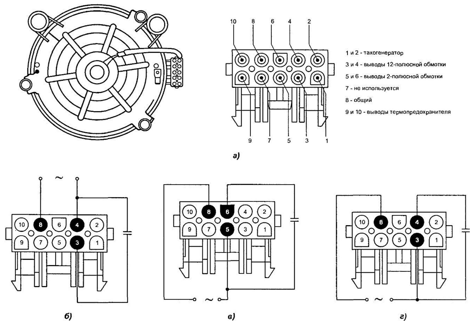
Рис. 16.14. Последовательность проверки асинхронного мотора с тахогенератором
