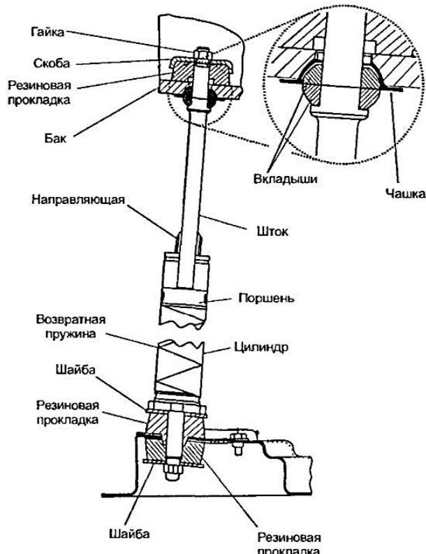
Рис. 1.6. Устройство пружинно-поршневого амортизатора
