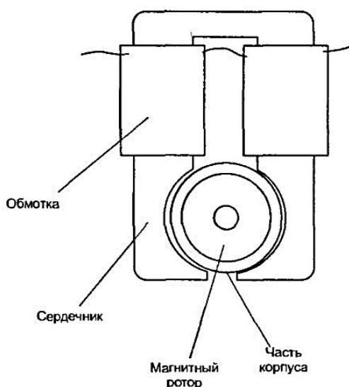
Рис. 14.5. Схема помпы с магнитным ротором
