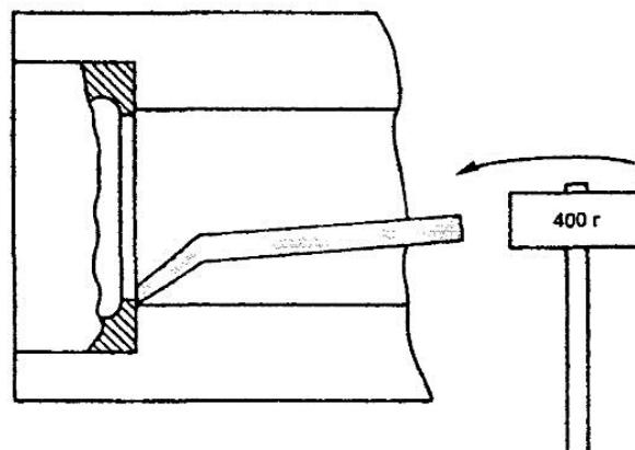
Рис. 18.7. Извлечение половинки обоймы подшипника
