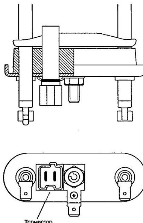
Рис. 9.14. Термистор встроенный в основание нагревательного элемента
