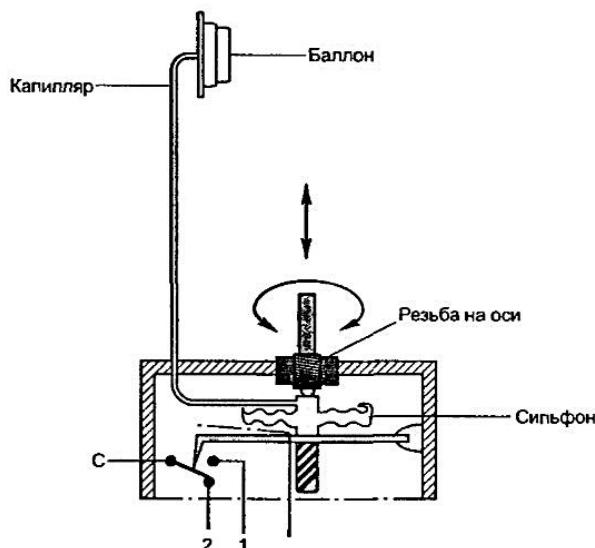
Рис. 9.8. Принцип действия регулируемого газонаполненного термостата
